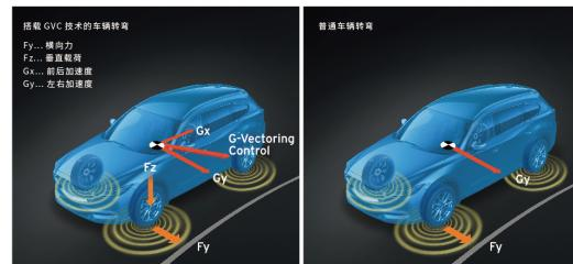
通过发动机提升底盘性能的全新控制技术
